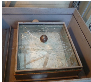
(d) Heat strengthened laminated glass(10.8T)
