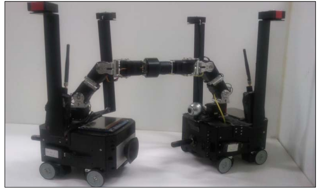
그림 2. 물리적 결합 가능한 모듈형 로봇 Fig. 2. Modular robot with physical docking device
