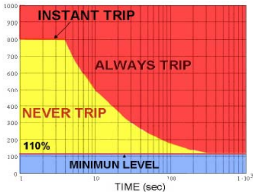
그림 5. RSSPC I^2t 커브 특성 Fig. 5. I^2t curve characteristics
