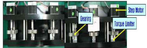
<그림 2> 전기 모터(Motor)의 시험 장치 구성
