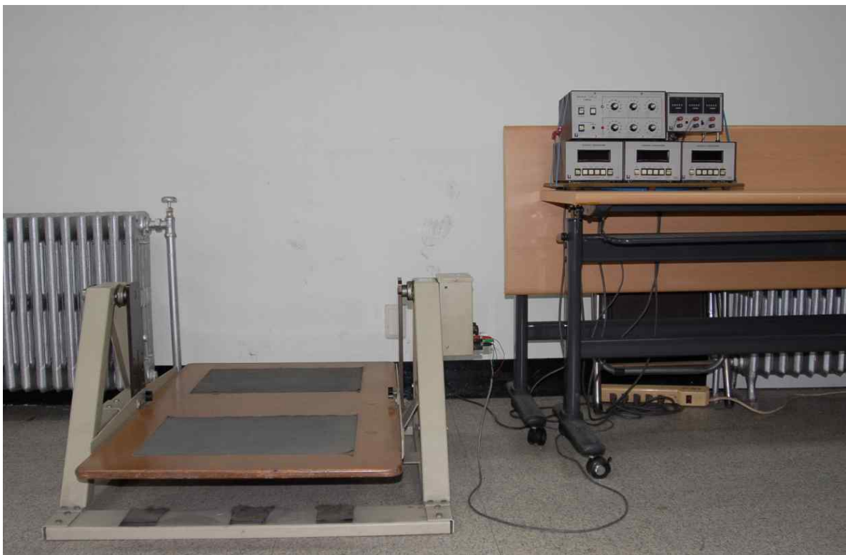
<그림 1> Lafayette사의 균형측정기(Stability Platform 16030)
