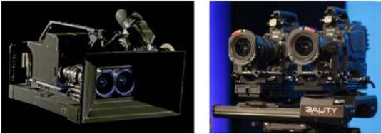
그림 2. 3D 카메라 시스템
