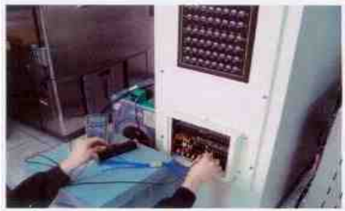
그림 2 배선 연결 커넥터의 접촉 저항 측정 Fig. 2 Measurement of contact resistance of wire connector
