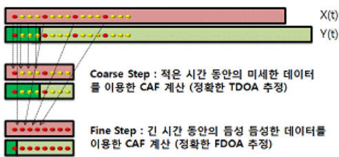
그림 4. coarse/fine 단계를 이용한 CAF 계산의 기본 개념
