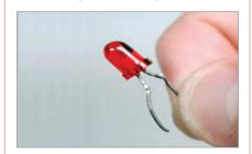
발광다이오드의 약자로서 전류가 흐르면. 빛을 방출하는 다이오드의 한가지 요소이 다. 화합물 반도체의 특성을 이용해. 전기 신호를 적외선 또는 빛으로 주고받는 반도 체의 일종으로 가정용 가전제품, 리모콘, 전광판, 표시기, 각종 자동화 기기 등에 사 용된다. LED에서 방출하는 빛의 색은 반도 체 칩 구성원소의 배합에 따라 파장을 만 들며, 이러한 파장이 빚의 색을 결정한다. 일반 백열전구에 비하여 LED는 소비전력 이 1/5밖에 안되고, 반응시간은 100만배나 빠르며, 수명은 반영구적이다. 각종 분야에 서 현저히 발달. 향상되어 전자표시판. 전 광판 및 각종 교통안전 신호등에 사용되고 있는 제품으로써 LED 전광판은 지속적으 로 기능이 향상되어, 텍스트 뿐만 아니라 이미지 전송과 풀 컬러 표출이 가능해져 보다 넓은 산업분야에서 응용되고 있다.
