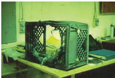
블랙스모커에서 분출되는 고온의 온천수로 인하여 녹아버린 플라스틱 유리바구니. 이 바구니는 잠수정 앨빈이 조사 중 채취한 시료 등을 담아두기 위하여 잠수정 앞에 놓여놓았던 것이다.
