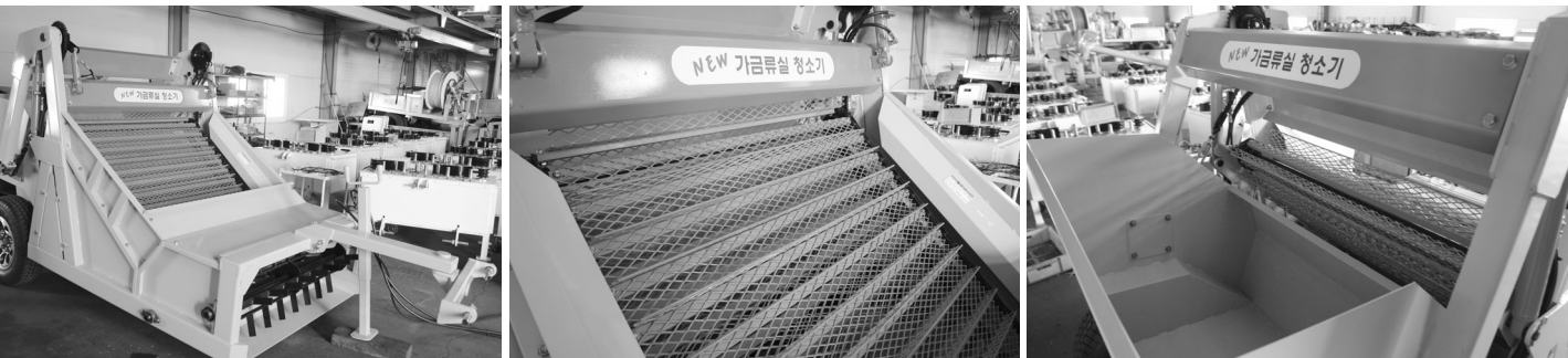
▲ 트랙터 부착형 ‘하우스키퍼’. 계분이 밑으로 들어가서 뒤집어져 윗부분으로 올라가면서 굳어있던 계분이 파쇄 및 분리되어, 깔짚은 다시 바닥에 깔리고 뒷부분의 적재함에 계분만 모아지게 된다. 적재함은 뒤집을 수 있는 구조로 되어있어 적당한 곳(분뇨처리시설 등)에 쏟아두거나 발효시킬 수 있다.
