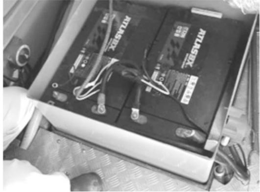
Fig. 6 배터리 결선상태 점검
