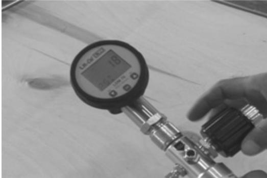
Fig. 40 경보 및 안전장치 작동시험
