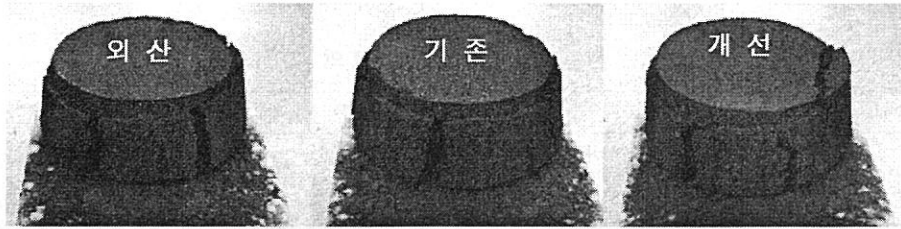
Fig. 4 시멘트 coating 부착 시험후 외관 상태
