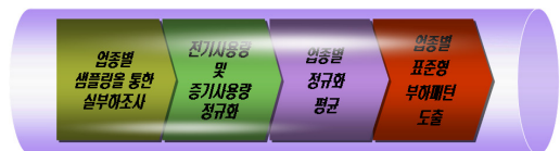
그림 4. 산업체 업종별 표준형부하패턴 산정 방법론 Fig. 4. Estimation of The standard energy pattern in industry
