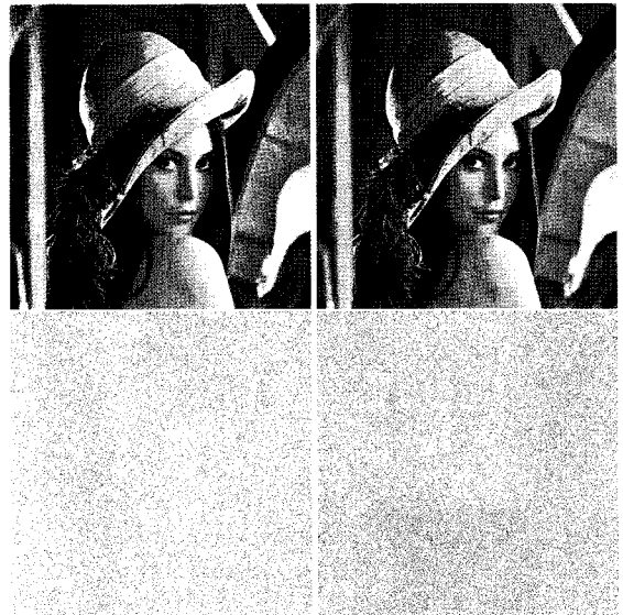
그림 8: 압축 결과: PSNR 37.5일때 JPEG(왼쪽 위), 제안한 방법(오른쪽 위), JPEG의 오차 영상(왼쪽 아래), 제안한 방법의 오차 영상(오른쪽 아래). 각각의 파일 크기는 24951 byte, 24560 byte이다.
