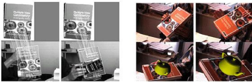
(그림 7) 특징점을 이용한 객체추적 방법
