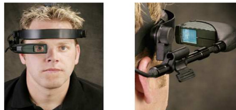
(그림 3) Optical see-through HMD(9)
