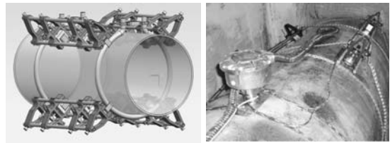
그림 17 멀티패스 크램프온 유량계 설치사진
