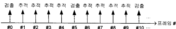
그림 2. 얼굴 검출과 얼굴 추적의 결합 Fig. 2. Integration of Face Detection and Face Tracking.
