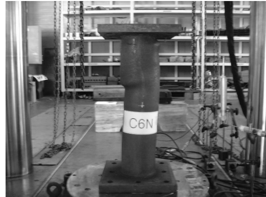
〈그림 9〉 기존 CFT 실험체의 파괴모습 (C6N 실험체)
