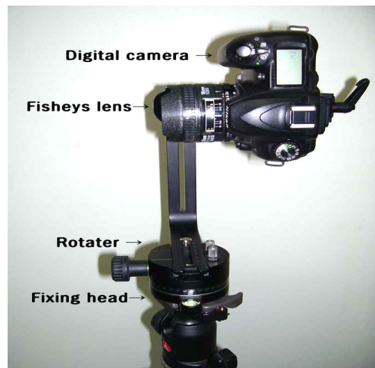
(그림 1) 문화재 촬영에 사용된 Spherical 방식 PVR 장비
