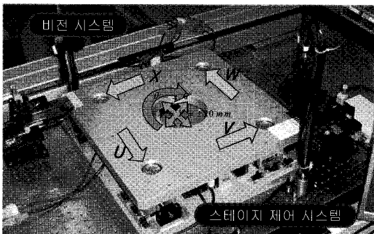
그림 1. 여유 구동축을 갖는 4PPR 병렬형 얼라인 스테이지. Fig. 1. 4PPR parallel alignment stage with actuation redundancy.
