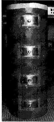
그림 1. 용량성 프로브의 설치. Fig. 1. Installation of the capacitive probe.
