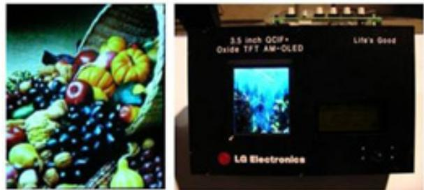
[그림 6] 산화물 TFT 소자기술이 적용된 3.5인치 AMOLED 패널 사진
