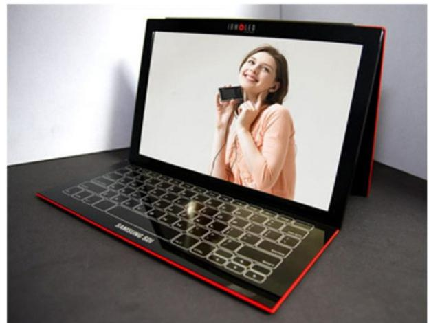
[그림 11] 바텀 게이트 구조의 InGaZnO TFT소자가 적용된 12.1인치 AMOLED 패널 사진
