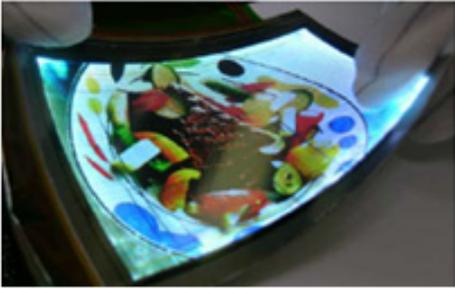
[그림 7] 금속 기판상에 산화물 TFT 소자를 이용하여 제작한 3.5인치 플렉서블 AM OLED 이미지
