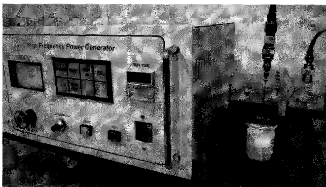
그림 4. 초고주파 발생기를 이용한 한천 팬텀가열 사진 Fig. 4. A photograph of agarose gel phantom heated by microwave generator
