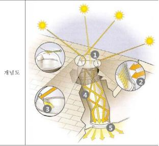
광 파이프 시스템은 자외선이 제거된 태양광을 실내에 유입할 수 있는 우수한 채광장치로 다른 시스템에 비해 값이 싸고 시공 및 유지관리가 비교적 간단하며 조광기의 설치로 필요시 부족한 자연광의 보완 및 인공조명과의 통합설계가 가능하다는 장점을 지니고 있다. 그러나설치 후 변경이 어렵고 유도관이 긴 경우 채광 성능이 떨어져 자연광의 유입이 실내 근거리에 제한되는 단점을
