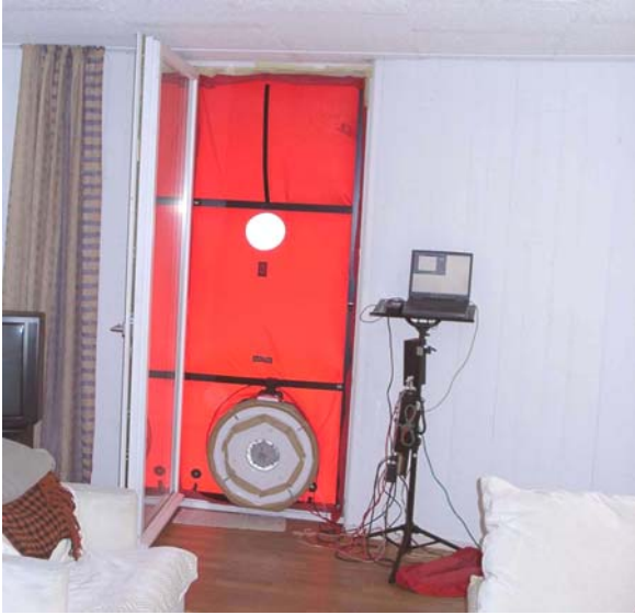
그림 9. 블로어-도어 테스트를 하는 모습
