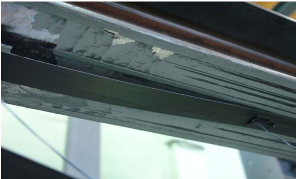
그림 5. SC Beam Series 부재의 파괴양상
