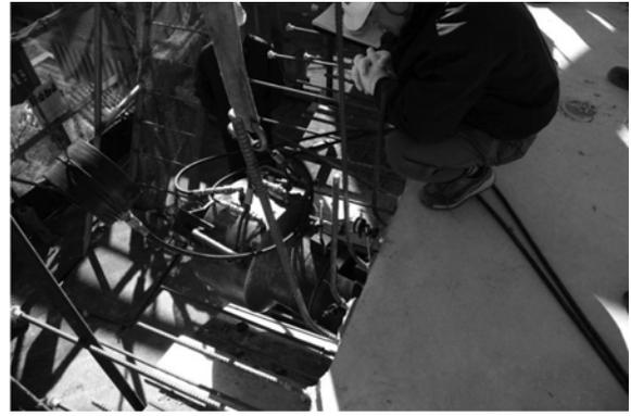
그림 4. Lift-off 시험
