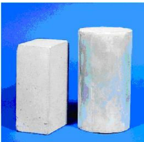
그림 2. 포틀랜드석 채석장에서 채취한 포틀랜드석(좌측)과 콘크리트 공시체(우측) 비교
