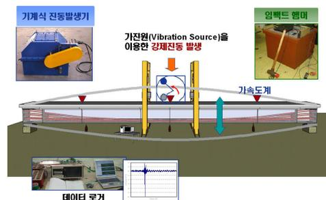
그림 3. 비대칭 매스에 의한 관성력을 이용한 가진기 및 충격해머에 의한 고유진동수 추출 방법
