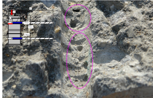
[그림 8] 2단수평 부착실험체 상단철근 하부 부착면
