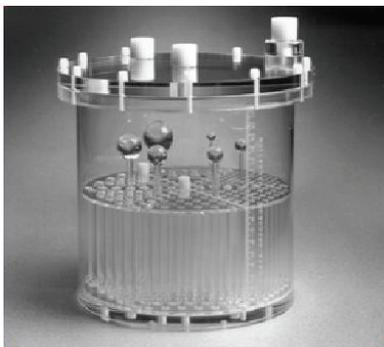
Fig. 2. Jaszczak phantom.
