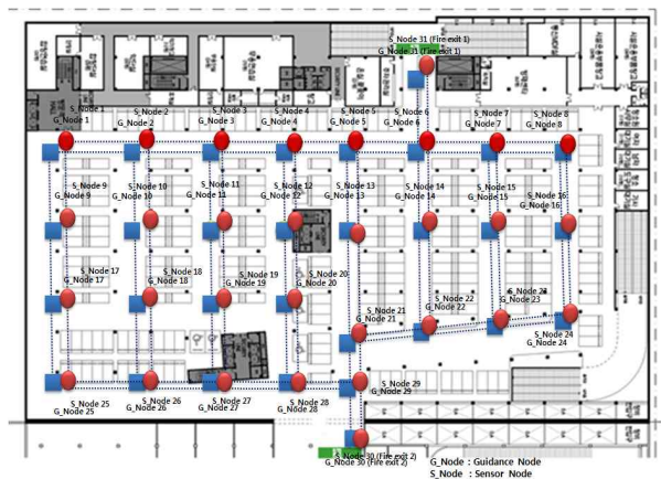
그림 3. 센서 네트워크와 유도등 네트워크 연결된 통합 논리 모델 Fig. 3. Integrated logical model connected between guidance light network and sensor network (example)
