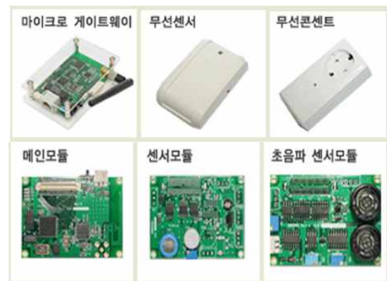
그림 4. 무선 센서 모듈(마이크로게이트웨이, 메인모듈, 센서 모듈)
