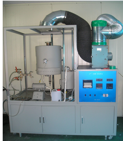
그림 2. 슬러지 활성탄 제작장치 사진
