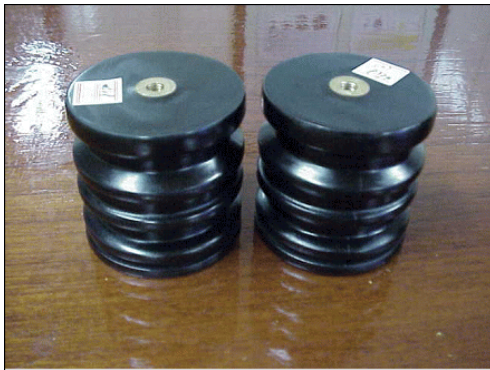
Fig. 4. Epoxy-mica capacitors fabricated in this study 그림 4. 본 연구에서 제작된 커패시터의 외형
