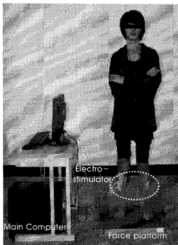
그림 3. 전기 자극 인가 및 신체동요도 측정 시스템 Fig. 3. The system for electrical stimulation & body sway measurement
