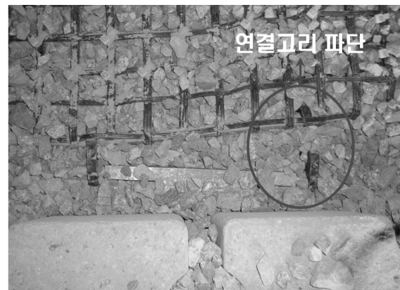
그림 11. 수직하중 80kN/m일 경우의 실험 종료 후 전경
