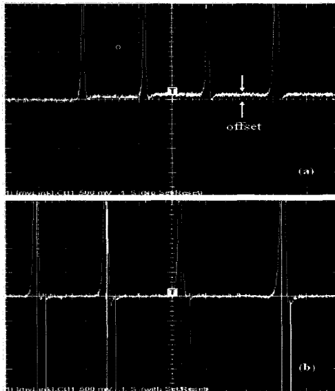
그림 3 KMZ51 출력파형 (a) 플리핑 전류 인가하지 않은 경우 (b) 플리핑 전류 인가한 경우 (x:1 s/div, y:500 mV/div) Fig. 3 Amplified outputs of a KMZ51 (a) without flip current (b) with flip currents (x:1 s/div, y:500 mV/div)
