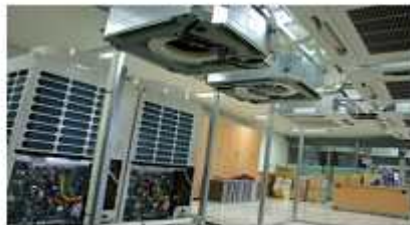
그림 1. 공조냉동 개발장비 (슈퍼 MMS(Multi Module System) 실험/실습장비)
