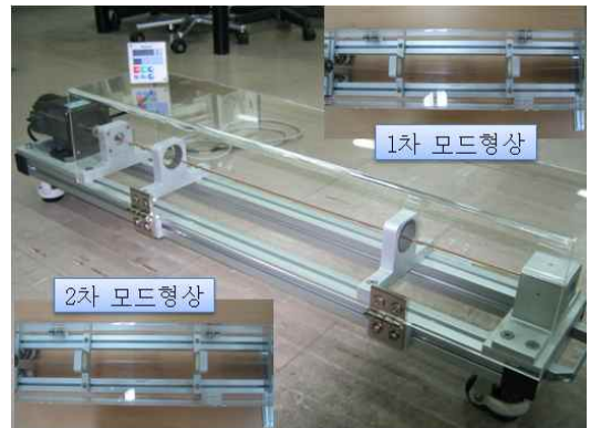
그림 1. 임계속도 측정용 회전체 교육장비
