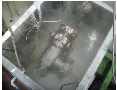
그림 3. LN2 환경에서 극저온 기밀시험 (연소기용 산화제 개폐밸브)
