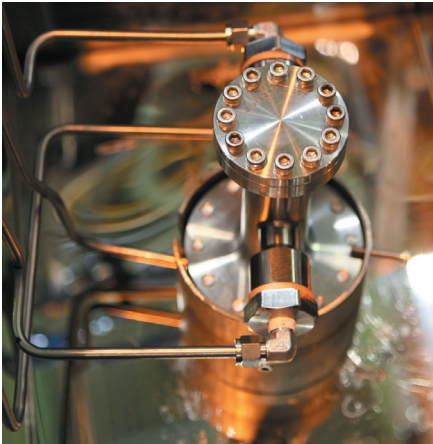
그림 6. LN2 환경에서 극저온 기밀시험 (가스발생기용 산화제 개폐밸브)
