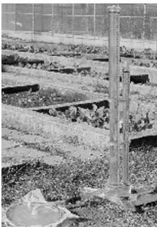
Fig 1. Disc tension infiltrometer (DTI).
