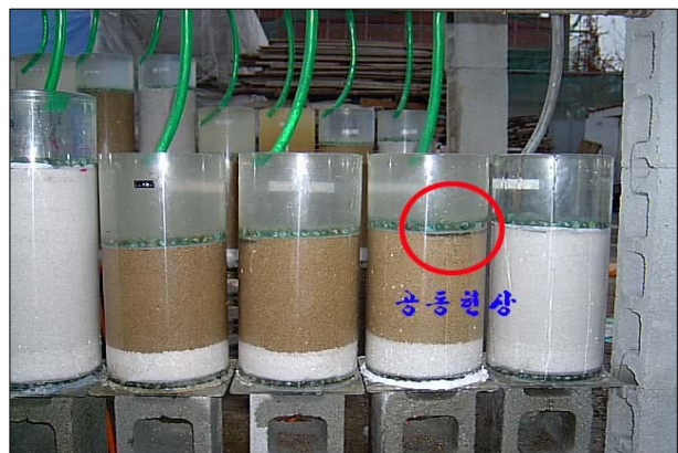
그림 4. 정수위투수계수 측정시험과 공동현상
