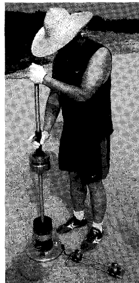
그림 2. LFWD 외형 및 실험전경
