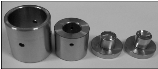
Fig. 17 Mold Mock-up of lens2
