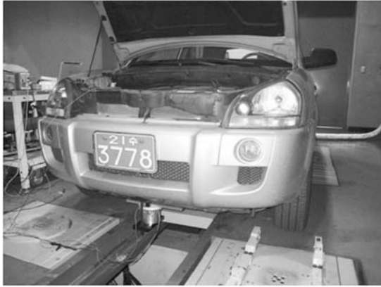
그림 9 시뮬레이션 실험에 사용된 차량 '투산' 과 ALA가 장착된 상태
