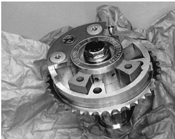
Fig. 1. 과공정 Al-Si 합금분말소재의 Chain Sprocket이 내장된 BMW 社の Camphaser System 8) .
