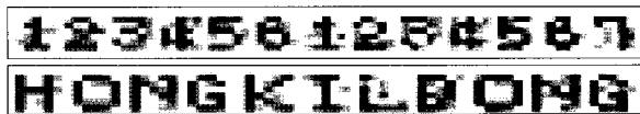
그림 6. 취급자정보 3회 반복 은닉 후 추출한 결과 (JPEG 30) Fig. 6 Result extracted of responsible person information (JPEG 30)
