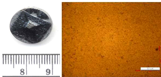
그림 3. Sm123 종자를 사용하여 승온시 900℃에서 3시간 유지시킨 공정을 거친 SLMG 방법으로 제조된 Y123 초전도체의 외관과 미세구조.
